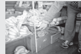
聞き取り調査で浸水位置を確認（水害痕跡調査）
